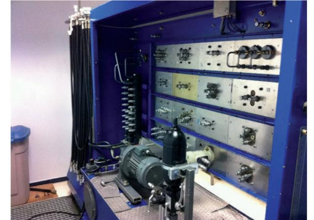
Ci-dessus, le banc vu de derrière avec le moteur entraînant le groupe hydraulique, l'accumulateur et son groupe de sécurité.
