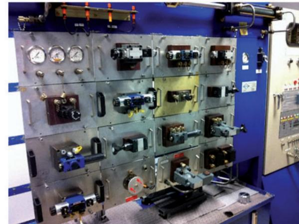
Le banc est constitué d'une armoire de commande électrique et d'une face permettant la dépose des composants sélectionnés pour le câblage. Au préalable, le stagiaire identifie les composants hydrauliques dont il a besoin et les positionne sur le banc. Il réalise ensuite le câblage hydraulique, les essais, la mise au point et le dépannage.
