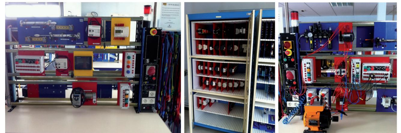
Le stagiaire sélectionne dans les armoires les composants dont il a besoin avant de débuter son câblage.
