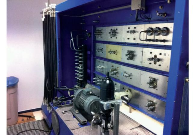
Le banc est constitué d'une armoire de commande électrique et d'une face permettant la dépose des composants sélectionnés pour le câblage. Au préalable, le stagiaire identifie les composants hydrauliques dont il a besoin et les positionne sur le banc. Il réalise ensuite le câblage hydraulique, les essais, la mise au point et le dépannage.
